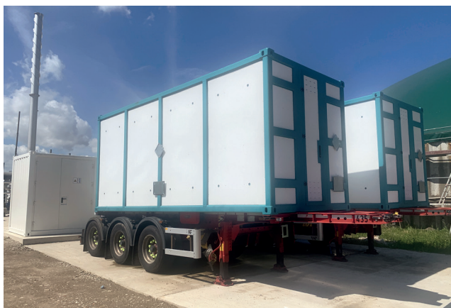
Abb. 20: Gastransportmodul auf Lkw-Trailer (© VÍTKOVICE CYLINDERS a.s.)
